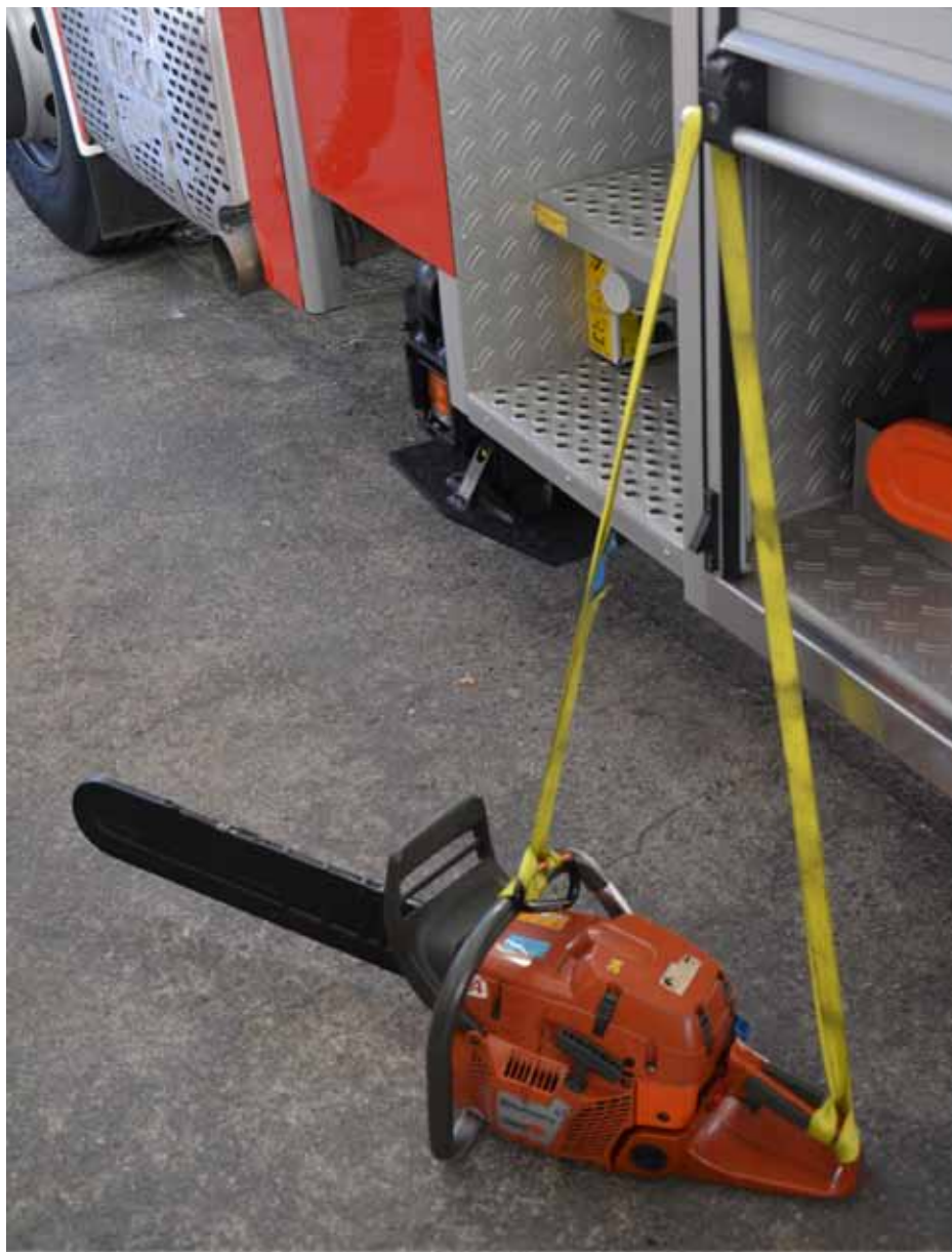
Motoros láncfűrész megkötése szállításhoz
